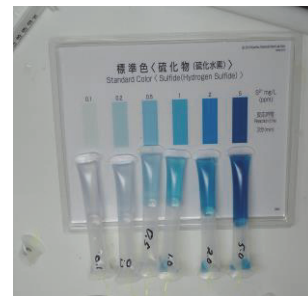
図-4 既知濃度硫化ナトリウム液による発色
