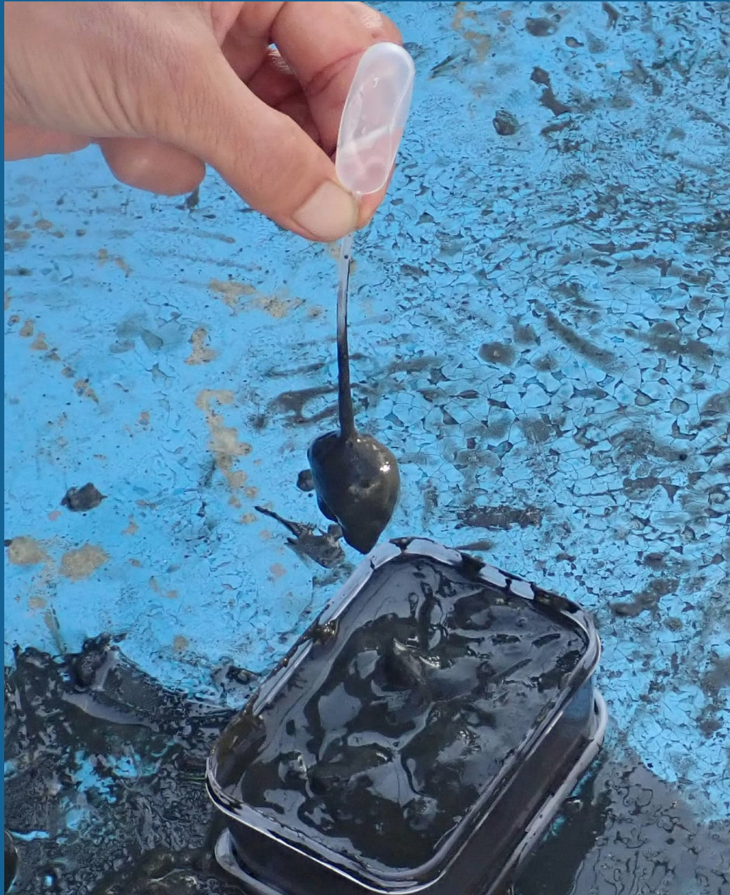
博多湾のヘドロ。間隙水を吸い取られた泥が団子状にろ紙にへばりついている。
